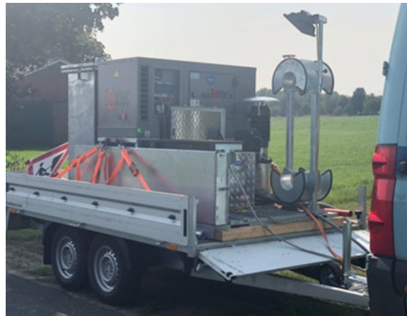
Abbildung 16: Bohranlage mit Zubehör auf Transportanhänger inkl. Tank für Spülbohrflüssigkeit
