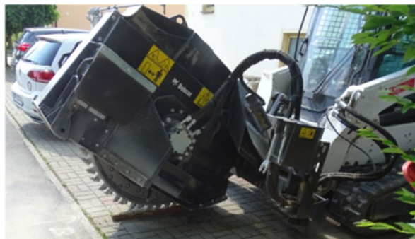
Abbildung 35: Frontal eingebaute Fräsmaschine
